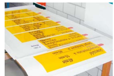
Abb. 21 Digitaldruck: Farbpulver oder -tinte wird auf eine Folie aufgetragen. Diese wird anschliessend auf den Wegweiser geklebt.
